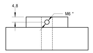
Gewindekernloch 5 mm gemeinsam mit Spindel bohren. Danach Gewinde in Zahnriemanscheibe schneiden
